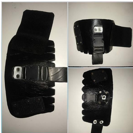
Figura 2 - Férula de Harris desenvolvida no LABTA.
