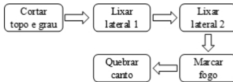
Figura 3 - Fluxo do processo do bloco inferior para o modelo B
