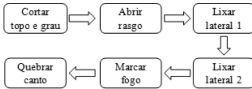
Figura 2 - Fluxo do processo do bloco inferior para os modelos A e C
